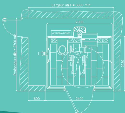
Confort et solidité : parois en polyester blindé six teintes RAL au choix avec une cuvette fixe en polyester armé SANS ABATTANT et dotée d'accessoires en inox anti-vandalisme indémontables côté public.
