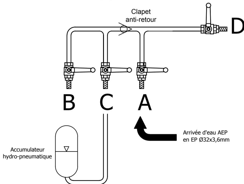
**NOTA:** Les vannes d'arrivée d'eau sont au lot Sagelec. Néanmoins, le tuyau d'alimentation AEP en EP Ø32x3.6 est à la charge du client et devra être passé et raccordé au compteur avant notre intervention. Il aura une longueur minimale de 3 mètres en sortie de fourreau.
